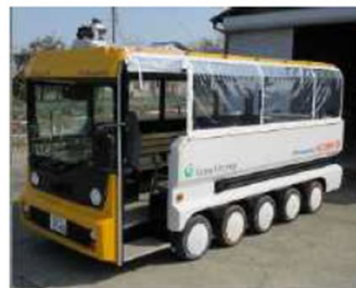
【実験車両】 eCOM10(自動運転機能を搭載した低速電動バス) 【走行条件】 ・テストドライバー乗車有 ・モニター乗車有 ・自動運転レベル2相当(特定条件下での自動運転)
