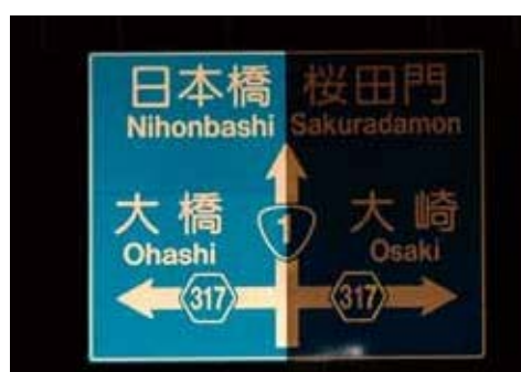
超高輝度の広角プリズム型（左）と高輝度のカプセルレンズ型（右）の違い
