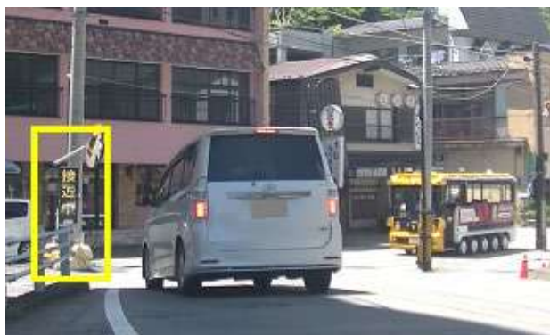
■参考：カーブ手前において、自動運転バスが近づくことを一般車両に知らせる「ICT LED 電光掲示板」 表示内容_（左）「自動運転バス 接近中」、（右）「このさき 自動運転バス」
