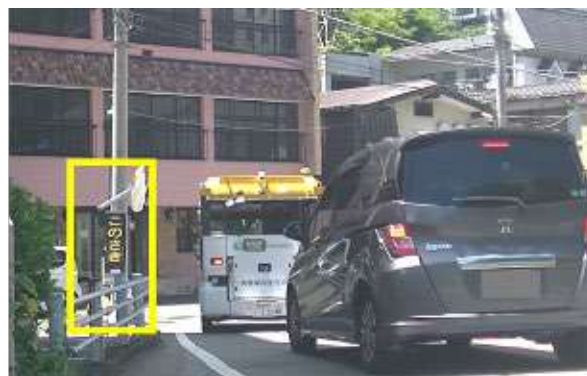
■参考：カーブ手前において、自動運転バスが近づくことを一般車両に知らせる「ICT LED 電光掲示板」 表示内容_（左）「自動運転バス 接近中」、（右）「このさき 自動運転バス」
