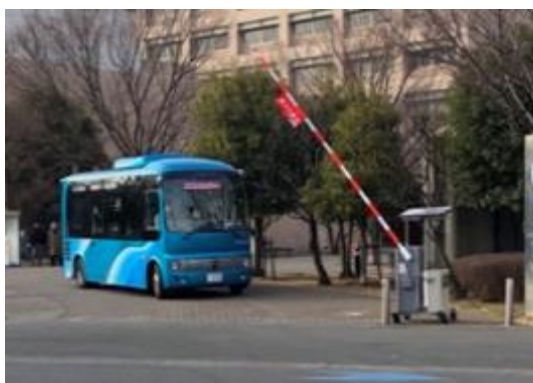
■左：ICT ゲート、右：ICT ゲート設置による確保できる自動運転バス専用空間
