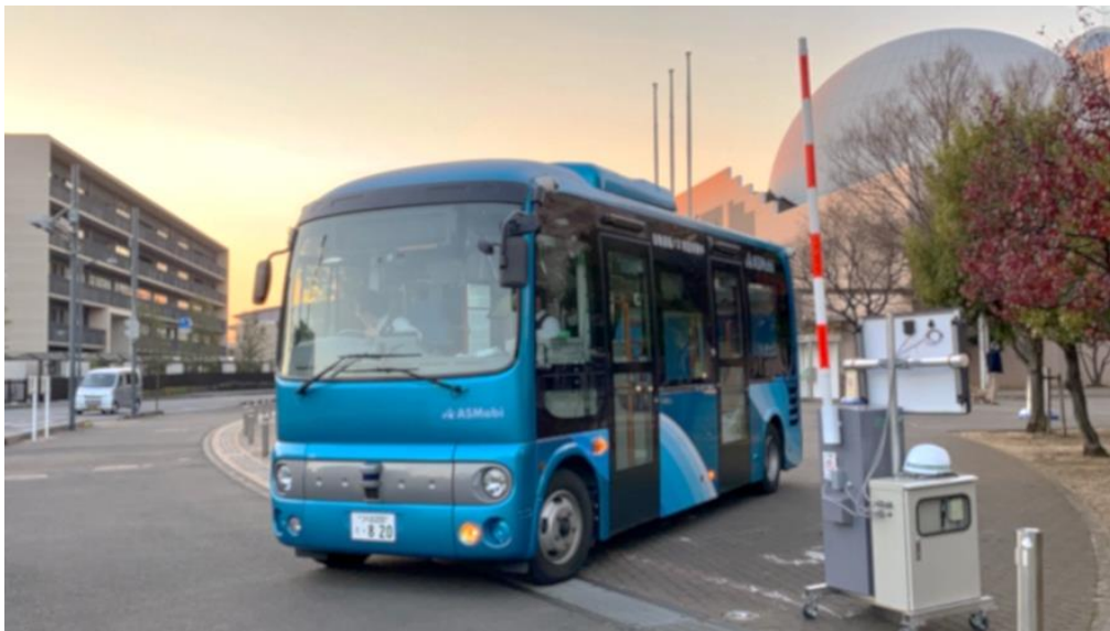
■自動運転バスに反応し ICT ゲートが開いている様子（川口市提供）
