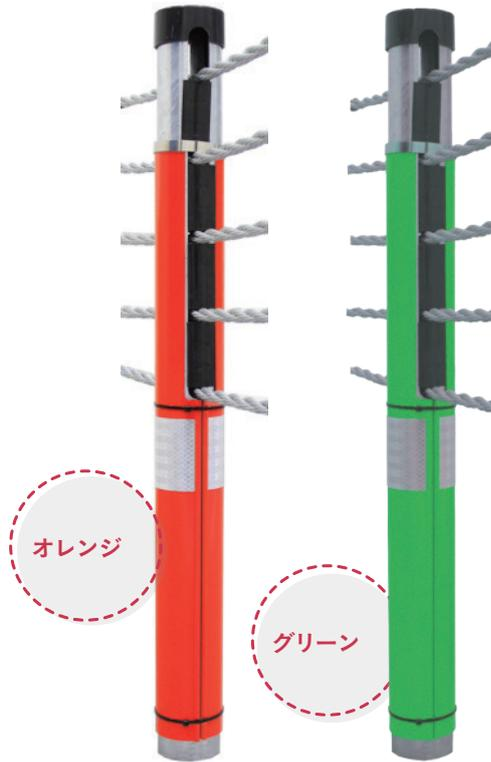
ワイヤロープ式防護柵は車両衝突時に支柱だけが倒れ、ワイヤロープは高さを保持し、そのたわみで車両を元の車線に戻す仕組みです。
