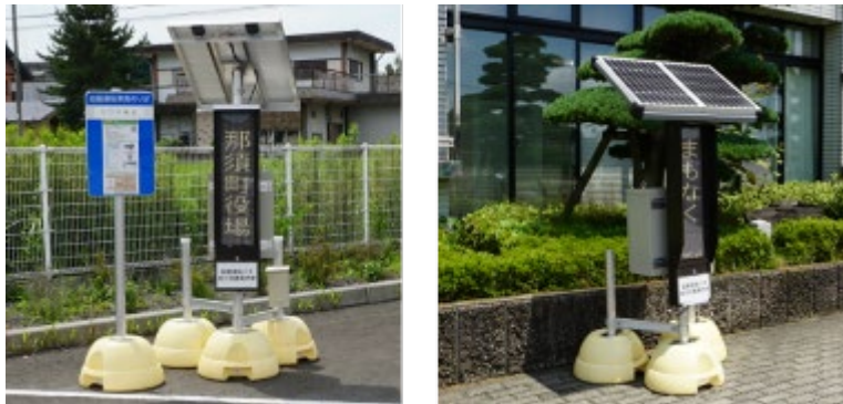
■停留所において自動運転バスが近づくことを知らせる「ICT LED 電光掲示板」（栃木県那須町実績）
