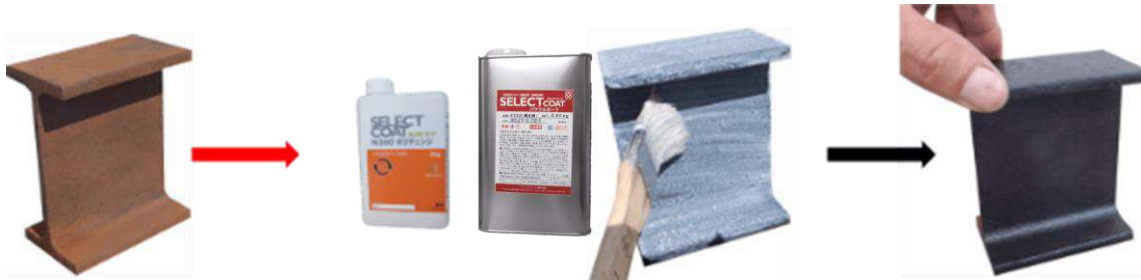
■（左）赤さびの供試体、（中央）セレクトコートさび鉄構造物リニューアル工法の実施、（右）黒さびに転換
